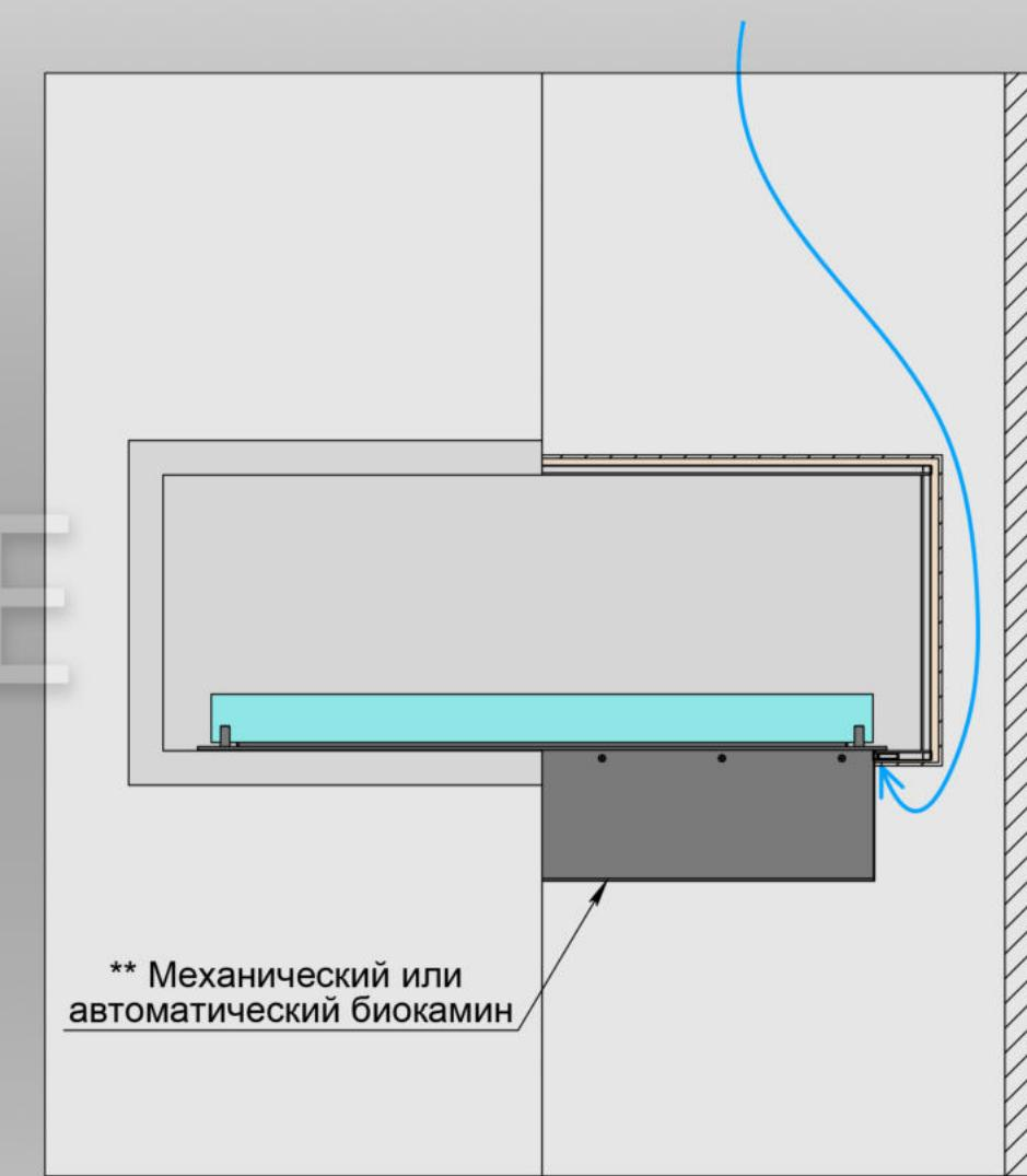
Установка очага в полую стену конструкция, которой открыта выше и ниже ниши для очага (без дополнительных перегородок). Тёплый воздух внутри стены будет вызывать негативные потоки, которые негативно скажутся на линии огня. Запрещённый вариант монтажа.
